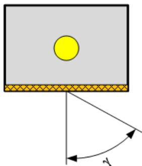
Abbildung 10: Ausstrahlwinkel  $\gamma$  bei mittels durchleuchtenden optischen Elementen abgeschirmten Lichtquellen
