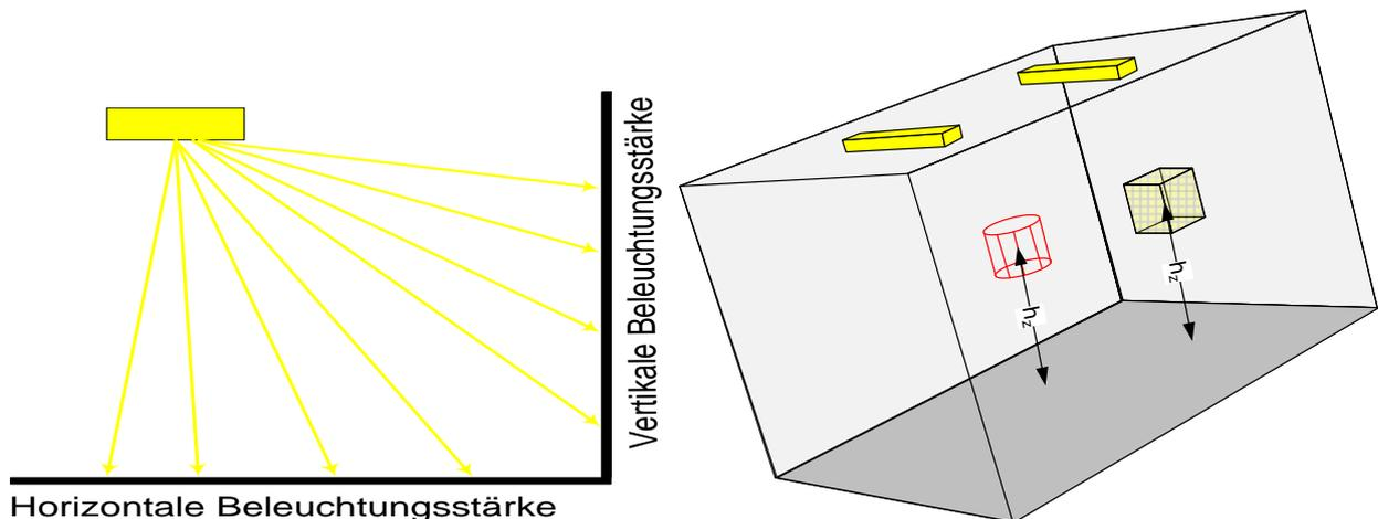
Abbildung 4: Schematische Darstellung von horizontaler bzw. vertikaler Beleuchtungsstärke (links) und zylindrischer Beleuchtungsstärke (rechts)
