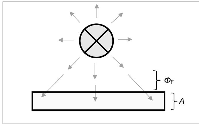
Abbildung 3: Schematische Darstellung der Beleuchtungsstärke  $E$  (Lichtstrom  $\Phi_F$  auf der Fläche  $A$ )
