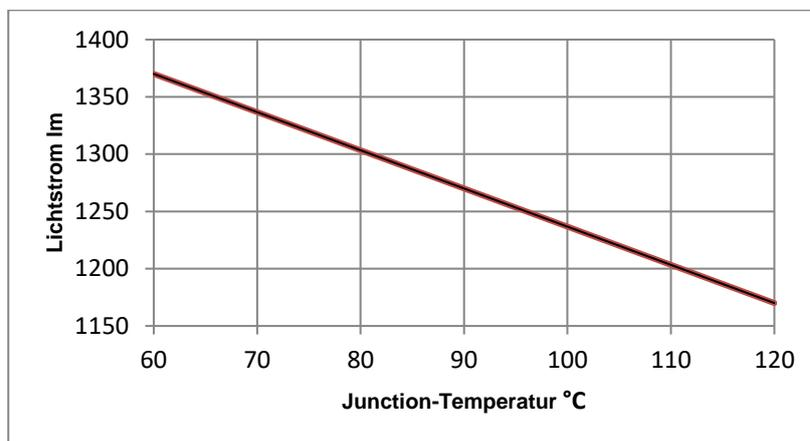
Abbildung 13: Beispielhafter Lichtstrom in Abhängigkeit von der Junction-Temperatur [71].
