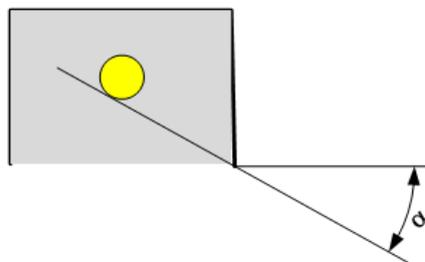
Abbildung 9: Abschirmwinkel  $\alpha$  bei Leuchten mit direkt sichtbarer Lichtquelle
