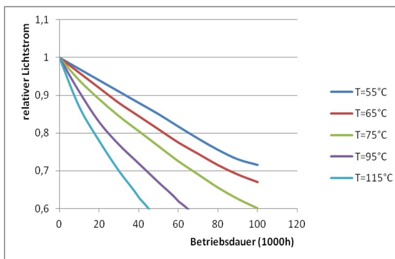
Abbildung 14: Beispielhafte relative Lichtströme in Abhängigkeit von der Junction-Temperatur und Betriebsdauer [71].
