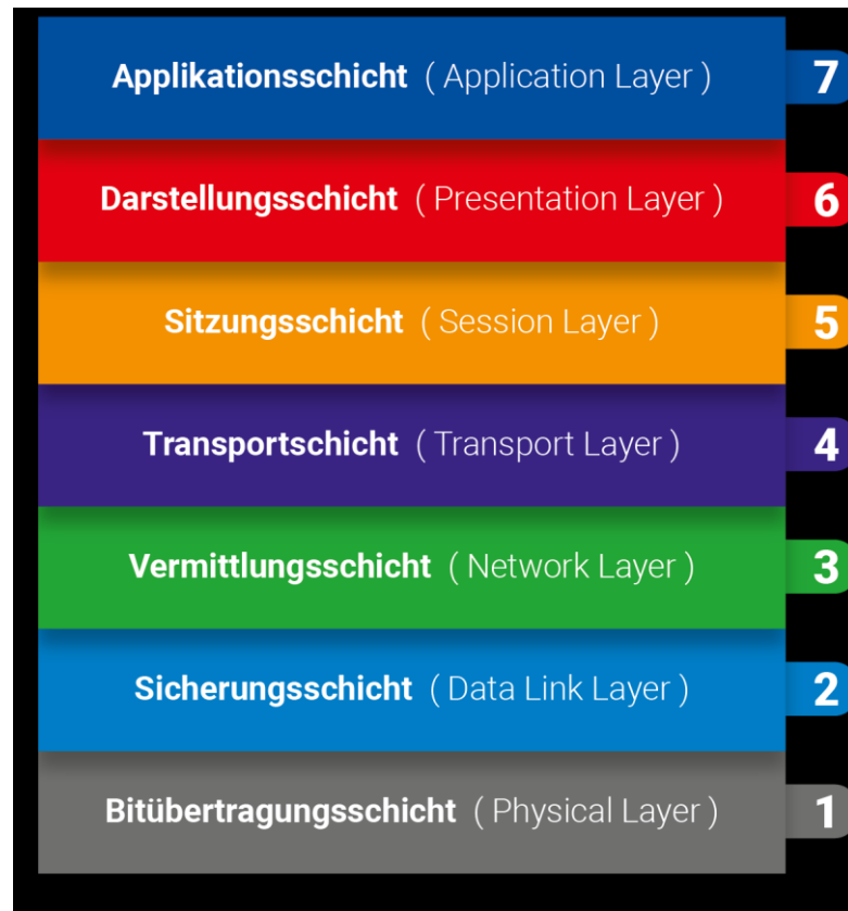
Abbildung 2: Kommunikationsbeziehungen nach OSI 7-Schichten Referenzmodell.
