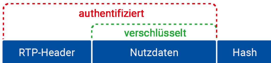
Abbildung 21: Darstellung eines SRTP-Paketes
