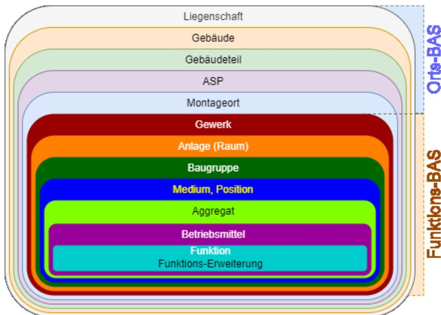
**Abbildung 2 BACTwin-BAS mit Orts-BAS als Schalenmodell**
